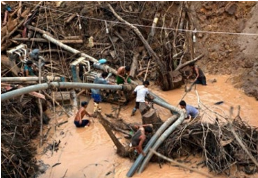
Figura 20: Vista de chupadera en campo.
