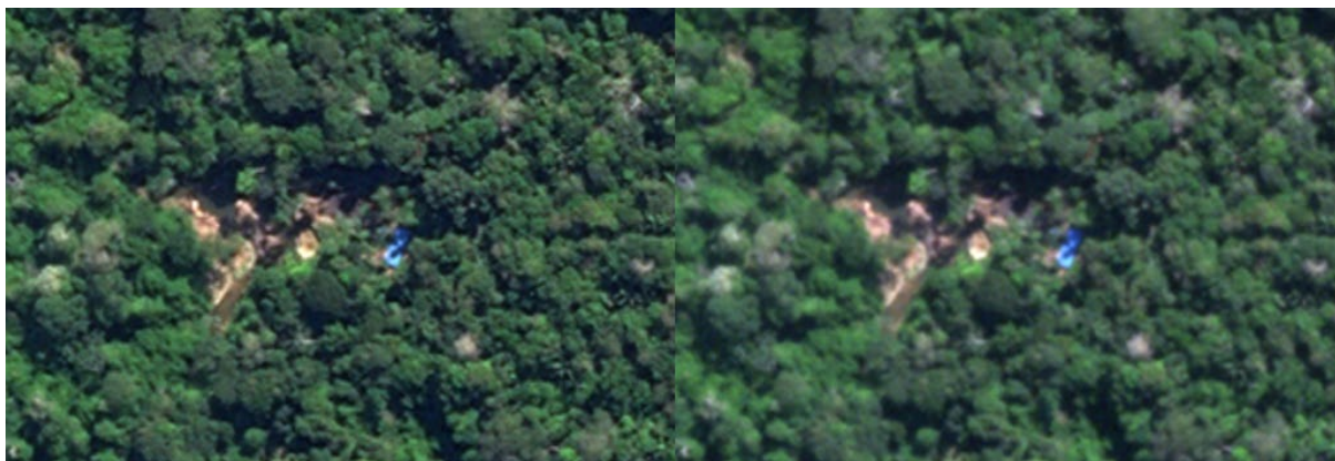
Figura 1: Diferencia entre el producto Ortho-Pansharpened (izquierda) y el producto Surface Reflectance (derecha).
